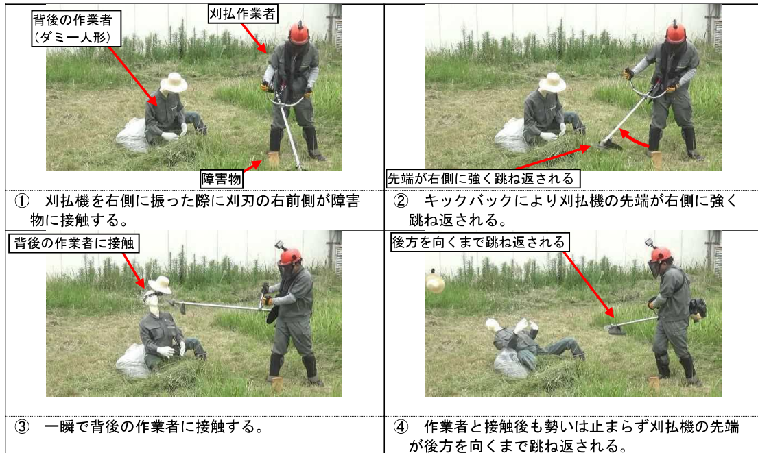
写真8. キックバックによって刈払作業者の後方の別の作業者に刈刃が接触した様子
